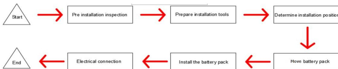
Beginn → Prüfungen vor der Installation → Bereitung der verwendeten Werkzeuge → Feststellung der Installationsposition → Bewegen des Batteriesatzes → Installation des Batteriesatzes → Elektrische Anschlüsse → Beenden
